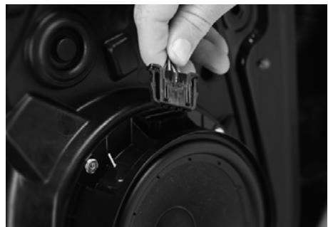
Les connecteurs du woofer du kit IC 165VW sont identiques à ceux d'origine utilisés par la marque Volkswagen®.
